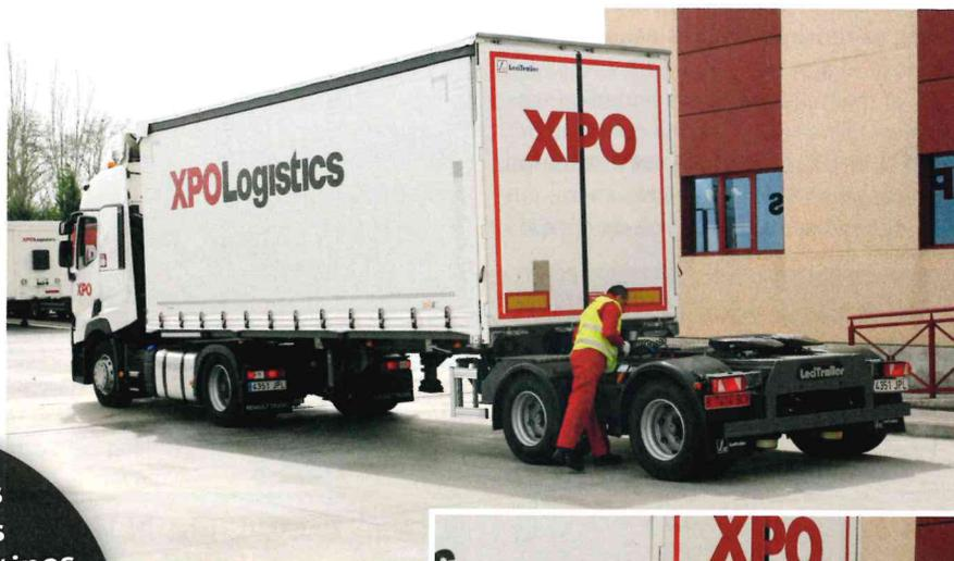
Los ejes del link tráiler se bloquean para permitir su extensión o compresión, pudiendo utilizarse en este caso como un semirremolque corto.
